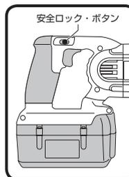
このレシプロソーのスイッチには安全ロック・ボタンが付いています。(左図を参照ください。) この工具を持ち運ぶ際や保管する際、急に作動して事故を引き起こすのを防止するため、必ず安全ロック・ボタンをかけた状態にしてください。
