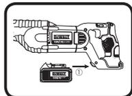
充電電池を本機に取り付けるとき、充電電池の向きが工具ハンドル部分下にある挿入口と合っていることを確認し、「カチン」としっかりはまるまで電池を差し込んでください。
