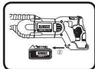
充電電池を工具から取り外すとき、充電電池の前面にあるリリース・ボタンを押したまま、充電電池を下に引きますと工具から外れます。
