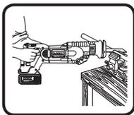
ソー・ブレードの種類により、金属の切断能力は異なります。ソー・ブレードを選ばれるとき製品の仕様、用途をよく読み、作業の内容に適したブレードをお選びください。通常、歯数が多いブレードの方がきれいに仕上がります。薄い金属板を切断される際、金属板の両面を木材ではさみ、クランプで固定することをお勧めします。この方が振動や金属切断部のまくれを防止し、きれいに仕上がります。切断作業中、無理な力をかけて切断することはソー・ブレードの寿命を著しく短縮させますのでおやめください。
