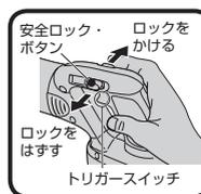
図にあるよう、安全ロック・ボタンを解除してください。トリガースイッチを引くとモーターに電源が入ります。トリガースイッチをはなすと電源が切れます。トリガースイッチには無段変速機能が組み込まれていますので、強く引くと高速、弱く引くと低速と速度を調節することが可能です。作業の用途により、引き金の引き具合で速度を調節できますので、大変便利です。
