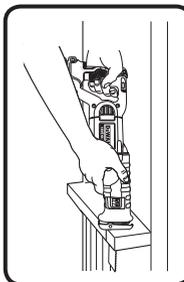
ソー・ブレードを従来の逆向きに装着することにより床や隅、困難な角度等も切断作業が容易に可能です。
