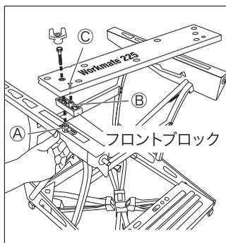
(4) 突起を上側に向けたフロントブロックをピボットナットの突起 (A) に差し込んで重ねます。
