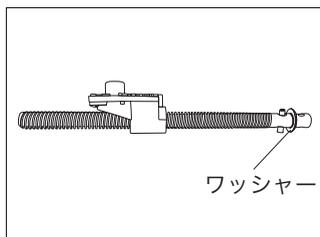
(2) 左図のように、バイススクリューをピボットナットに半分くらいまで回しながら通し、反対側にはワッシャーを通してください。この際、ピボットナットの向きに注意してください。(※合計2セットの組み立てを行ってください)。
