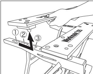
ワークメイト本体フレームにはバイス（後）の位置を変更できるように3箇所（左図①～③）穴が開いています。変更したい場合は、左図矢印のように手前にスライドさせながら引き上げ、再度使用したい穴に逆の手順で取り付けてください。
