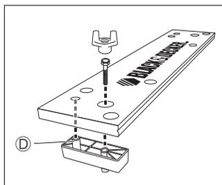
(2) リアブロックの突起（Ⓓ）をバイスの穴に通し、もう一方の穴から、ソケットレンチを使ってボルトを留めます。
