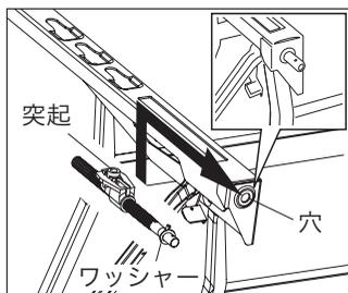
(3) (2) で組み立てたバイススクリューをピボットナットの突起が上になるように持ち、左図矢印の通り、本体内側から手前の穴に差し込んでください。
