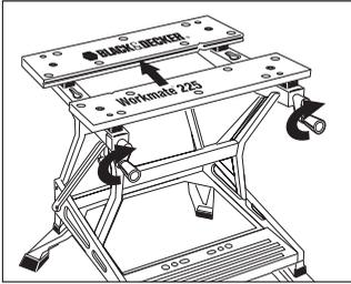
両方のバイス調整ハンドルをに回すことでバイス（前）の位置が変更できます。時計回りに回すことでバイス（前）が奥に移動し、反時計回りに回すことでバイス（前）が手前に移動します。
