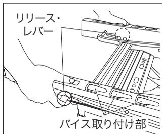
(1) ワークメイト本体のバイス取り付け部を上にして床に置き、左右の端にあるリリース・レバーに指をかけます。
